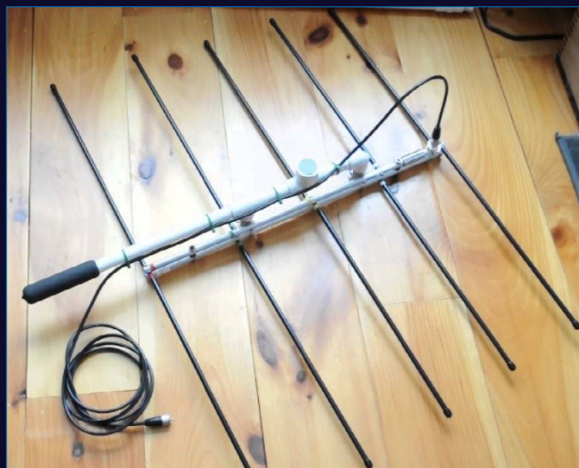
Antena aperiódica tipo ELK (V/U)
