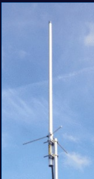
Antena vertical bibanda tipo X-30, X-50, X-200, ...
