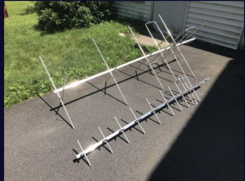
InnoVAntennas 10 elementos UHF X-Pol y 5 elementos VHF X-Pol
